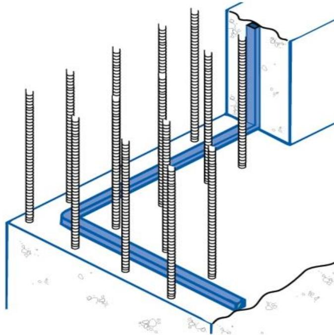
염분 및 염수와 접촉하여 팽창하는 순응성의 팽창성 고분자 / 부틸 고무 방수 스트립. 쏟아진 콘크리트로 완전히 캡슐화되면 팽창력이 콘크리트면에 대한 씰을 형성합니다. 씰은 정수압에 저항하여 하부 구조로 물이 들어오지 못하게 합니다.
